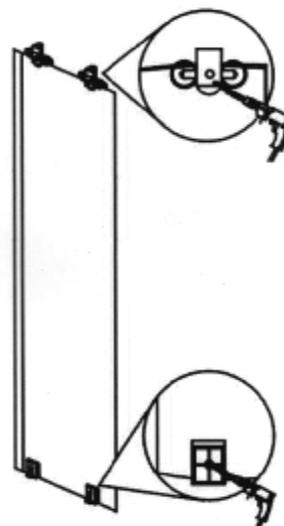
6.- Montar los rodamientos en la parte superior y los patinetes en la inferior de las correderas.
