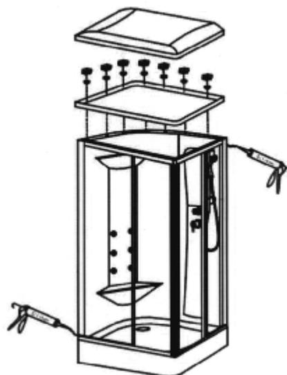
8.- Siliconar todas las juntas. Atornillar el techo. Colocar el cubre- techo y desplazar la cabina a su posición final.
