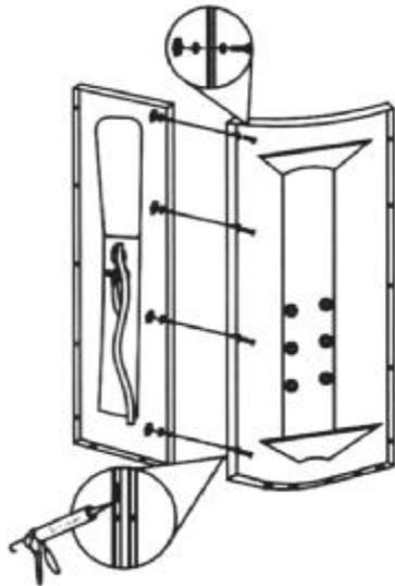
3.- Unir el panel lateral al cuerpo con los tornillos y siliconar la junta.
